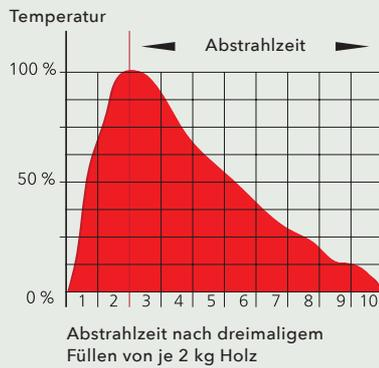
**Wärmespeicherblock - bis zu 5-fach längere Wärmeabgabe**
